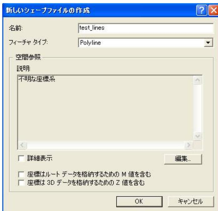
座標系は、世界測地系（GRS80 楕円体、ITRF94 系）で、平面直角座標系第6系に設定します。
