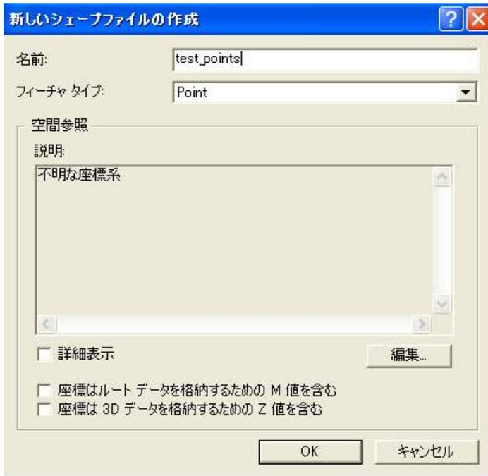
座標系は、世界測地系（GRS80 楕円体、ITRF94 系）で、平面直角座標系第6系に設定します。
