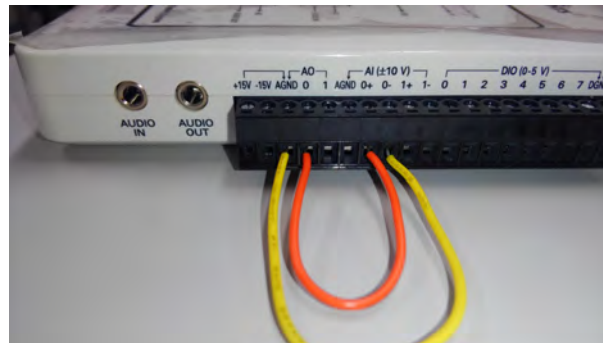
図 2.3 myDAQ と端子台, ジャンプワイヤの接続
