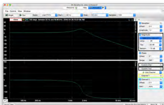
図 10.2 Network Analyzer による周波数特性測定結果
