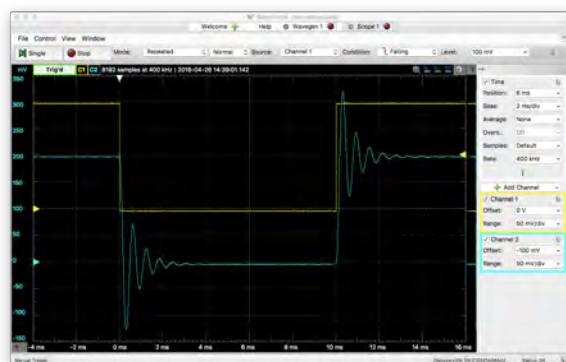
図 8.2 コンデンサ電圧の過渡応答 ( R=10\ \Omega , L=10\text{mH} , C=1\ \mu\text{F} , f=50\text{Hz} )
