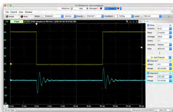
図 8.3 抵抗電圧の過渡応答 ( R=10\ \Omega , L=10\text{mH} , C=1\ \mu\text{F} , f=50\text{Hz} , Ch2 のレンジを拡大している)
