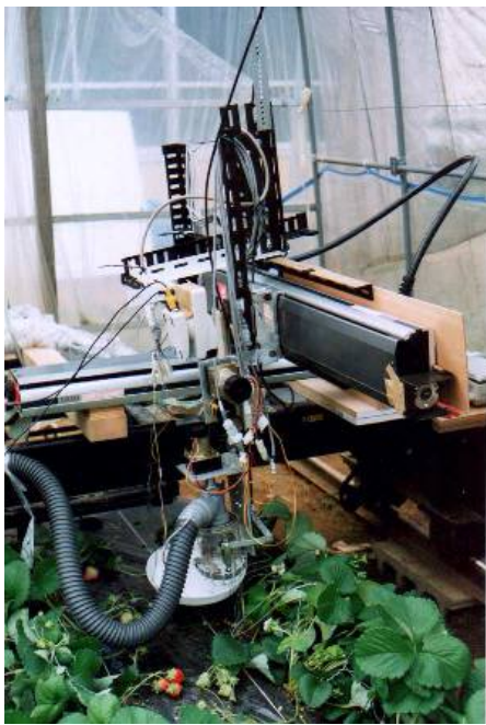
イチゴの内成り栽培と直角座標型マニピュレータ
