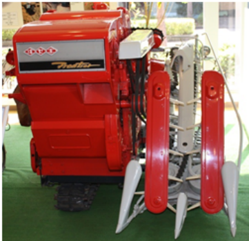
1966年 日本初 自脱コンバイン 井関農機(株) フロンティアHD50 2条刈(袋取)、9馬力 L2000×W1700×H1300、580kg
