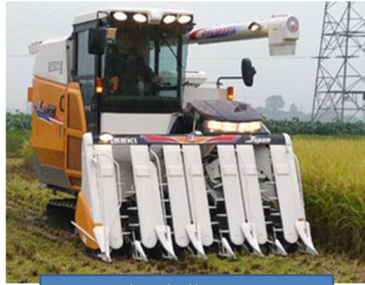
2009年 自脱コンバイン 井関農機(株) X17120 7条刈(グレーンタンク)、120馬力 L5060×W2490×H2680、4950kg 作業能率6～35分/10a
