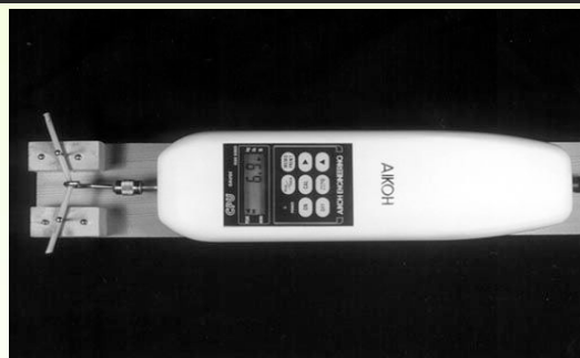
図1 デジタルゲージと自作の両端支持ばり固定台 (アイコーエンジニアリング(株), デジタルプッシュゲージ9520A)
